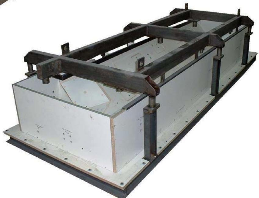
*Moule pour bâti de centre d'usinage*
